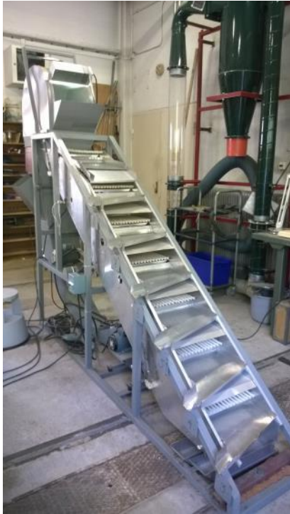
Figur 2. Sorteringsmaskine ved JTI - Institutet för jordbruks- och miljöteknik, SLU i Uppsala, Sverige. Til venstre ses hele sorteringsmaskinen, hvor der bagerst var en blæser, der holdt halmen "svævende" (luft). Den "svævende" halm blev ført ind på en række sold forrest på maskinen. Halmen blev rystet på soldene, så de længste strå blev frasorteret øverst og de korteste længere nede. På billedet til venstre ses et udsnit af disse sold og opsamlingsbakker.
